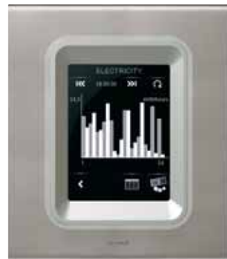
3,5" dotykový panel v módu měření spotřeby
